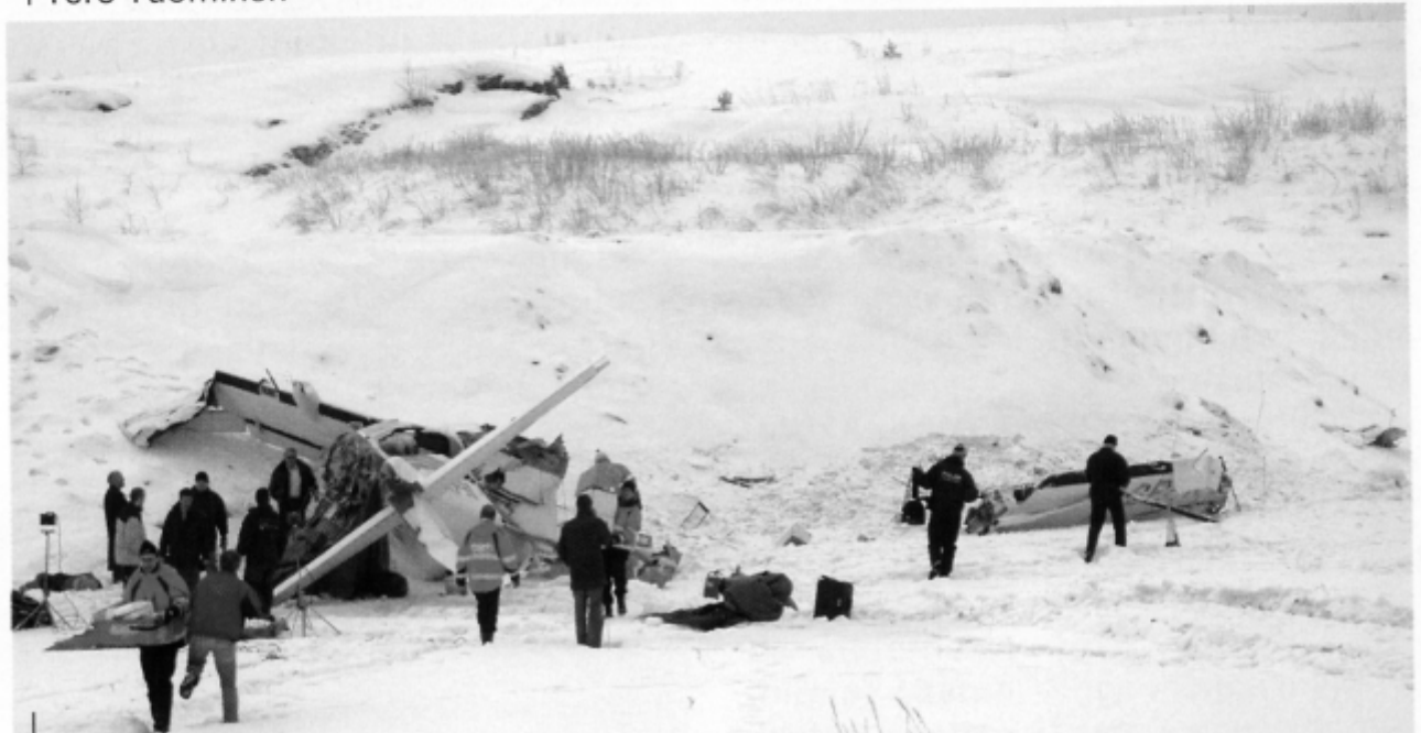
Cessna 208B hajosi pahoin, mutta ohjaamo säilyi suhteellisen ehjänä. Kuva Tero Tuominen
